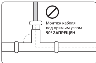
Неправильный монтаж кабеля в трубу
